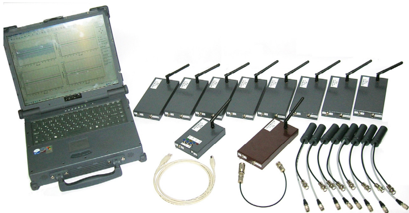
Рис. 6. Загальний вигляд блоків макета восьмиканальної радіотелеметричної системи акустико-емісійного моніторингу стану об'єктів тривалого експлуатування [24]
