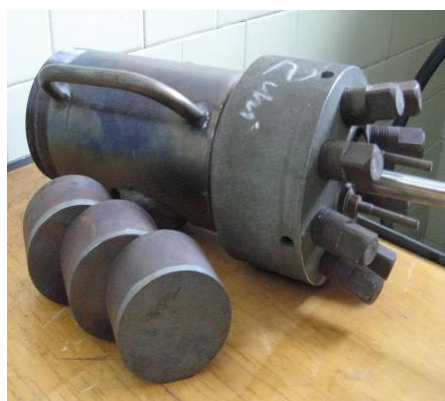
Рис. 7. Циліндричні зразки з напавкою (а) та розрахункова схема (б): 1 – основний метал (сталь 2,25Cr-1Mo); 2 – напавка (сталь типу 347).
