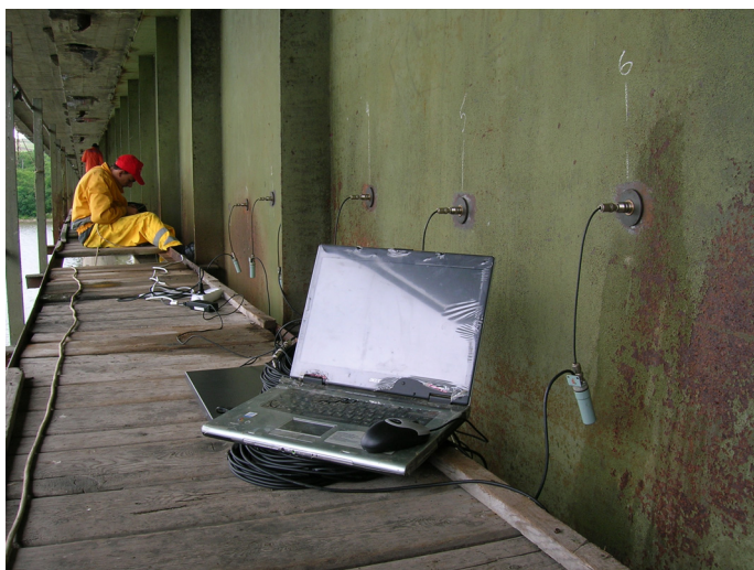
Рис. 3. АЕ-діагностування секції металевої несучої балки моста через р. Дністер.
