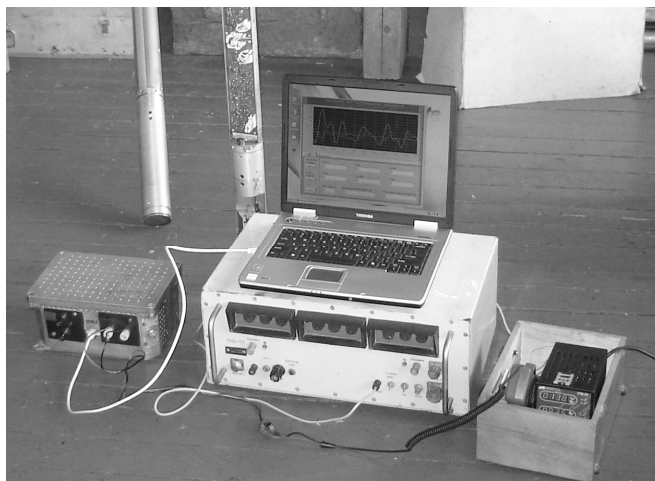
Рис. 10. Дослідження енергетичних характеристик ЕНА за допомогою мобільної комп'ютеризованої лабораторії на кафедрі ЕП і ЕО ІФНТУНГ
