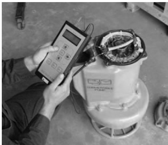
Рис. 8. Вимірювання параметрів електродвигунів за допомогою приладу ALL-TEST IV PRO™ 2000
